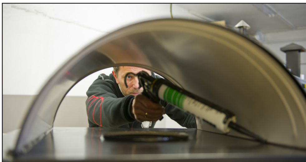
Skorsteinen blir nøyaktig målt for å få et perfekt pipebeslag. Deretter tegnes et design som passer taket, og beslaget blir laget etter kundens valg av material og farge.
