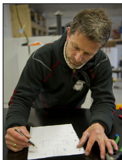
Skorsteinen blir nøyaktig målt for å få et perfekt pipebeslag. Deretter tegnes et design som passer taket, og beslaget blir laget etter kundens valg av material og farge.
